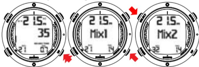
CHANGING GAS MIX. SCROLL THROUGH ENABLED MIXES BY PRESSING THE UP OR DOWN BUTTONS. SELECT NEW MIX BY PRESSING THE SELECT BUTTON.
