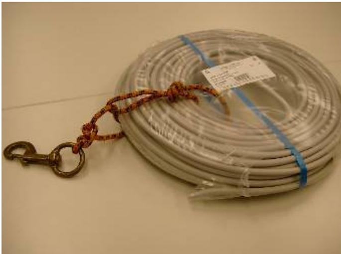
Das Kabel kommt in der Originalverpackung von 50m Länge in die Höhle. Es wird mit einem kurzen Seilstück und Boltsnap im Schulter-D-Ring eingehängt. Vorsicht, ist beim Hüft-D-Ring ein Schleppanker und sollte beim Tauchen keinen Felskontakt haben. Sonst massiv erhöhter Gasverbrauch! Das Kabel wird vor Ort dann aus der Mitte rausgezogen. So kommt es nicht zu einem Kabelsalat.
