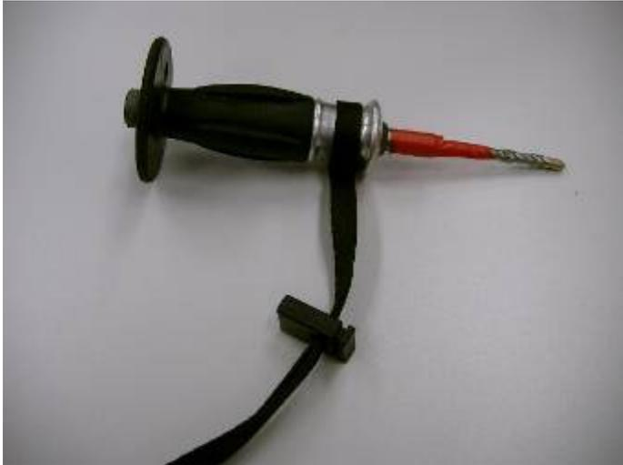
Zum Bohren wird der Rocpecker von Petzl verwendet. Es kann in der Höhle ein Bohrerwechsel gemacht werden. Die Bohrer werden entsprechend der Schraubentiefe mit Klebeband abgeklebt. So bohrt man die richtige Tiefe.
