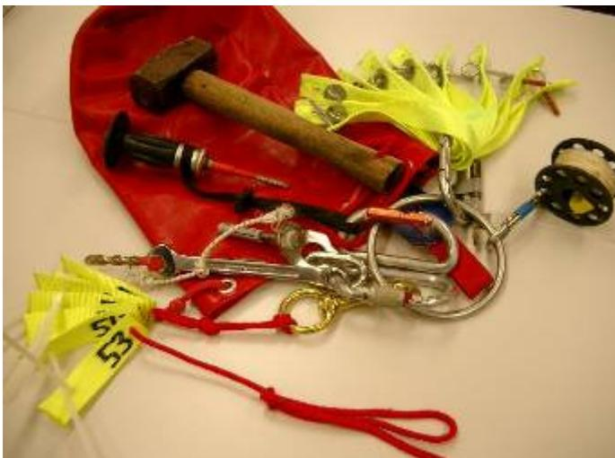
Inhalt des Materialsackes. Der komplette Inhalt wird an einem Chromnickelstahling oder ähnlichem befestigt. So kann man den Inhalt auch bei Strömung rausnehmen und verliert nichts.
