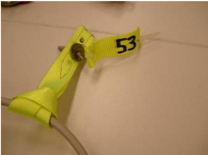
Befestigungsband mit Messpunktnummer. Montage mittels Kabelbinder. Dieser wird durch das zweite eingebraunte Loch geführt. So hebt sich die Nummer gut sichtbar ab.
