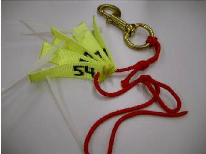
Die Leinenmarkierungen (Messpunktnummer, Distanz) wird mit wasserfestem Stift gemacht. Zusätzlich wird die Zahl mit einem LötKolben eingebraunt.
