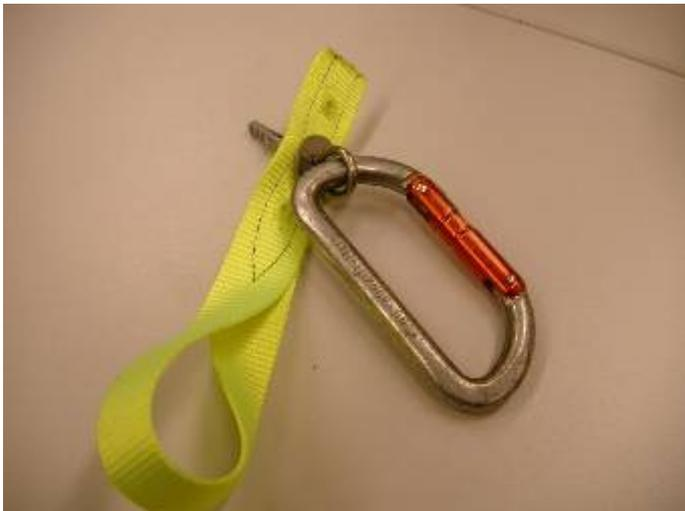
Die Ringschraube wird mit einem Karabiner angezogen. So kann später jederzeit ohne Werkzeug die Ringschraube wieder gelöst werden. Etwas schlechter geht auch ein Boltsnap.
