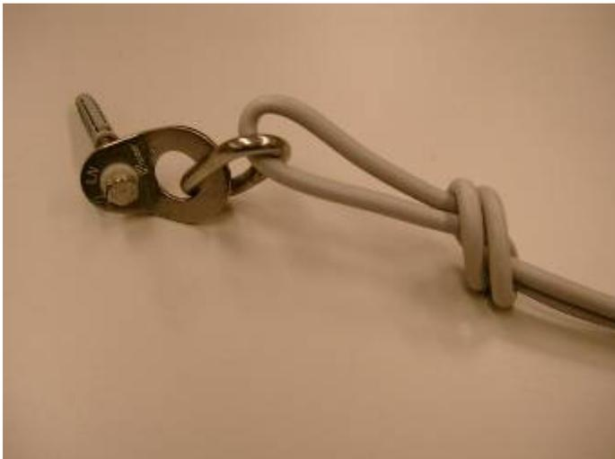
Kabel in den Ring eingeknotet. Überstehendes Kabel wird sauber abgeschnitten. Das nächste Kabel wird ebenfalls in den Ring geknotet.
