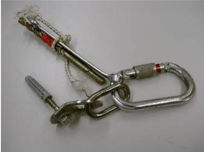
Nach 50m Kabel oder bei heiklen Punkten kommt ein stärkerer Verankerungspunkt zum Einsatz. Chromnickelstahlplättli mit Ring.
