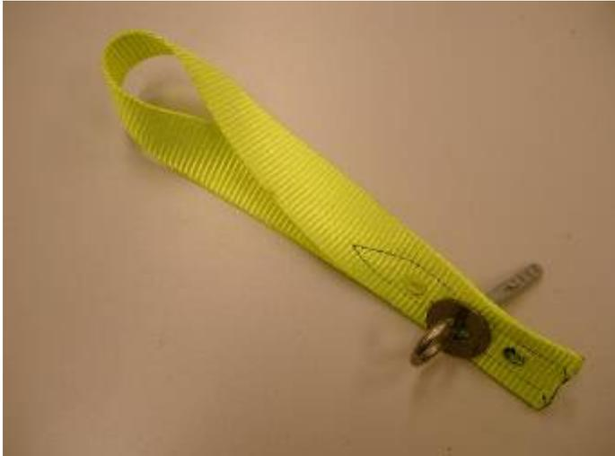
Befestigungsband mit der Reißfestigkeit von 1000kg, Längs und Quer nicht weiterreißbar, fluoreszierend. Das Band wird verdreht zusammen genäht und die Löcher mit einer heißen LötKolbenspitze eingebrannt. Dazu Kunststoffdübel Ø 6mm, Ringschraube Chromnickelstahl und eine Unterlagsscheibe.
