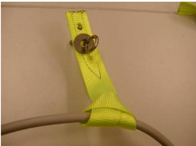
Das Befestigungsband wird gemäss dem Bild in das Kabel eingeknotet. Das Kabel kann gut gespannt werden und über die verschiedenen Löcher kann die Länge justiert werden. So ist das Kabel bei richtiger Leinenführung immer weg vom Fels.
