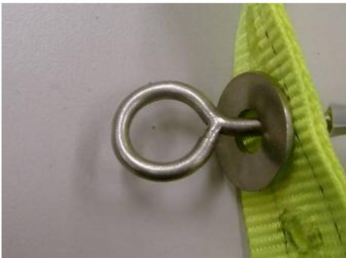
Die Ringschraube muss verschweisst sein. Sonst hält sie den Belastungen nicht Stand. Durchmesser Holzgewinde 4,5 – 5,0mm. Länge 30 – 32mm.
